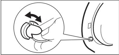
Zum Schließen der Tür drehen Sie die Vorrichtung gegen den Uhrzeigersinn, bis sich die Einkerbung in senkrechter Lage befindet.
