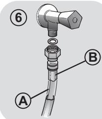
**WASSERSCHUTZ (Abbildung 6):** Sollte Wasser aus dem Hauptschlauch „A“ austreten, schützt die Hülle „B“ vor kompletten Wasseraustritt.
