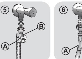
● **AQUAPROTECT – TUBO DE ALIMENTACIÓN CON PROTECCIÓN (fig. 6):** Si el tubo principal "A" pierde agua, el depósito transparente "B" contiene agua que permite que se complete el ciclo de lavado. Al finalizar el ciclo, solicitar al Servicio de Atención al Cliente el reemplazo del tubo de entrada de agua.
