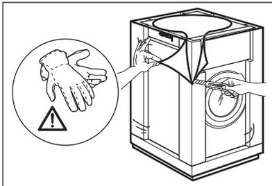
2. Entfernen Sie die Karton-Abdeckung und Styroporverpackungsteile.
