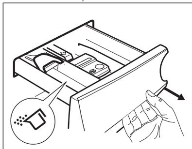
4. Drehen Sie die Klappe nach unten, wenn Sie Flüssigwaschmittel verwenden.
