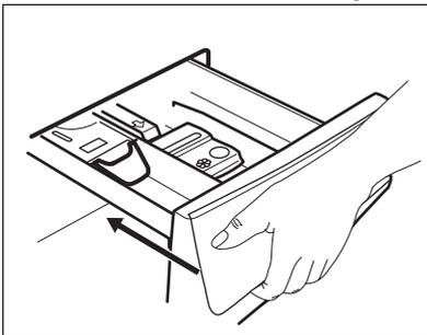
Achten Sie darauf, dass die Klappe beim Schließen der Waschmittelschublade nicht blockiert.
