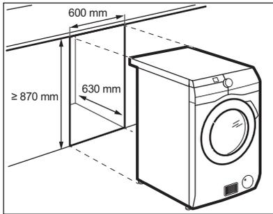
Das Gerät kann freistehend oder unter einer Küchenarbeitsplatte in einer Nische mit den entsprechenden Abmessungen montiert werden (siehe Abbildung).
