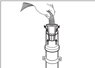
5. **Ohne Kunststoffführung in einen Siphon** - Stecken Sie den Ablaufschlauch in den Siphon und befestigen Sie ihn mit einer Schlauchschelle. Orientieren Sie sich an der Abbildung.
