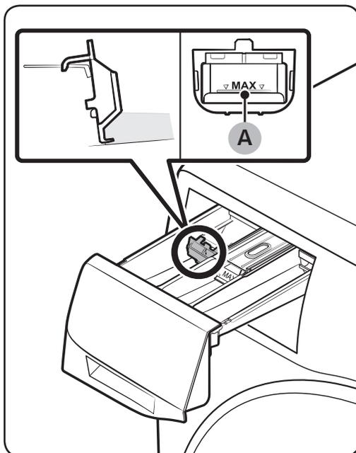
Stecken Sie zunächst den Flüssigwaschmittelbehälter in das **II** **Waschmittelfach Hauptwäsche** ein. Füllen Sie dann Flüssigwaschmittel bis unter die **Maximallinie (A)** in den Behälter ein.
