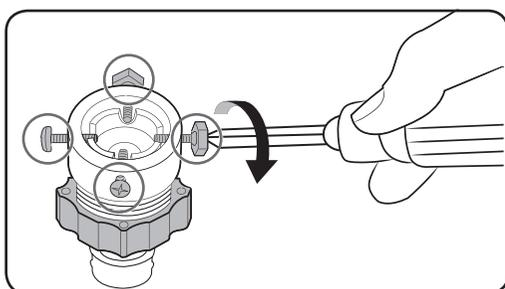
2. Lösen Sie die vier Schrauben am Adapter mithilfe eines Philips-Schraubenziehers.
