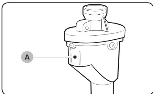
Der Wasserschlauch warnt Benutzer vor der Gefahr eines Wasserlecks. Er spürt, wenn Wasser fließt, und die mittlere Anzeige (A) wird im Falle eines Lecks rot.
