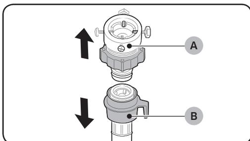
**Schließen Sie den Zuwasserschlauch am Wasseranschluss an.**
