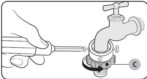
4. Führen Sie den Adapter in den Wasseranschluss ein und ziehen Sie die Schrauben fest, während Sie den Adapter anheben.
