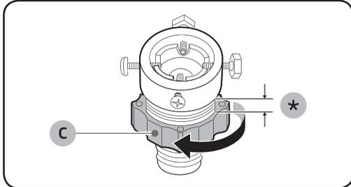
3. Halten Sie den Adapter fest und drehen Sie Teil (C) in Pfeilrichtung, um es um 5 mm zu lösen (\*).
