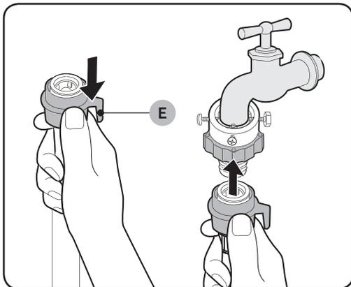
6. Während Teil (E) heruntergedrückt wird, schließen Sie den Zuwasserschlauch an den Adapter an. Lassen Sie dann Teil (E) los. Der Schlauch rastet mit einem Klickgeräusch im Adapter ein.
