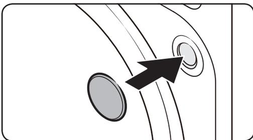
2. Verschließen Sie die Transportsicherungsöffnungen mit den mitgelieferten Kunststoffabdeckungen. Bewahren Sie die Transportsicherungen für einen späteren Gebrauch auf.
