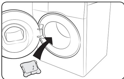
1. Legen Sie die Kapsel in die leere Trommel und nach hinten.
