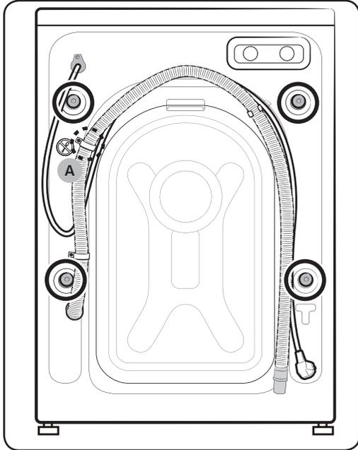
3. Schließen Sie alle Kunststoff-Schraubverschlüsse auf der Rückseite der Waschmaschine.
