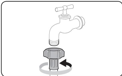
7. Wenn Sie einen Wasserhahn mit Schraubklammern verwenden, nutzen Sie den mitgelieferten Adapter mit Schraubklammern, um den Wasserhahn wie gezeigt anzuschließen.
