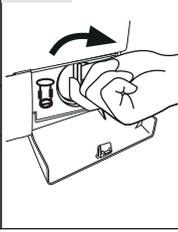
9. Fremdkörperfalle unter fließendem Wasser säubern. (Abb. 8-6.7)
