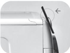
Wenn Sie die genaue Position der NFC-Antenne in Ihrem Smartphone nicht kennen, bewegen Sie das Telefon mit kreisenden Bewegungen vor dem Smart Touch-Logo auf der Bedienblende, bis die Verbindung in der App bestätigt wird. Um den ordnungsgemäßen Datentransfer zu gewährleisten, ist es wichtig, das **SMARTPHONE FÜR EINIGE SEKUNDEN VOR DIE BEDIENBLENDE ZU HALTEN**; nach erfolgtem Datenaustausch wird eine entsprechende Nachricht in der App angezeigt, dass das Smartphone entfernt werden kann.
