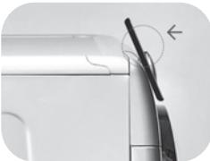
Se non si conosce la posizione dell'antenna NFC, spostare leggermente lo smartphone con movimento circolare sul logo Smart Touch fino a quando l'App segnala l'avvenuta connessione. Affinchè il trasferimento di dati vada a buon fine è fondamentale **MANTENERE IL TELEFONO APPOGGIATO SUL CRUSCOTTO DURANTE TUTTA LA PROCEDURA** (pochi secondi); una schermata sul dispositivo informerà sull'esito dell'operazione e quando sarà possibile allontanare lo smartphone.
