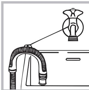
Oder hängen Sie den Ablaufschlauch in ein Becken oder eine Wanne ein; befestigen Sie ihn in diesem Falle mittels der Führung (beim Kundendienst erhältlich) an dem Wasserhahn (siehe Abbildung). Das freie
