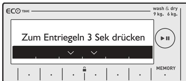
Wenn die Kindersicherung eingeschaltet ist, während ein Programm läuft, und der Programmwähler auf die Position CANCEL (Abbrechen) gedreht und ein anderes Programm ausgewählt wird, 8 Ubb wird das zuvor ausgewählte Programm an der Stelle wieder aufgenommen, an der es verlassen wurde. Es erfolgt keine Änderung.
