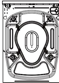
Die Transport-Sicherheitsschrauben müssen mit einem geeigneten Schraubenschlüssel zum Lösen nach links gedreht werden.
