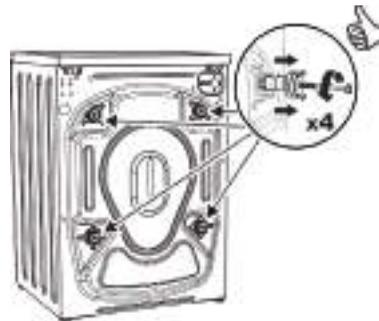
Danach müssen die Transport-Sicherheitsschrauben ganz heraus gezogen werden. Die entfernten Transport-Sicherheitsschrauben müssen gut aufbewahrt werden für den Fall, dass die Maschine erneut transportiert werden muss wie bei einem Umzug beispielsweise.
