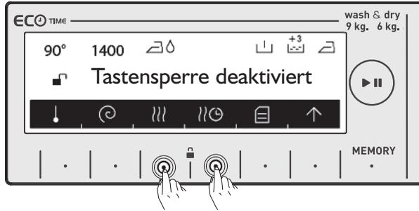
**Hinweis:** Die Kindersicherung kann weder den Pumpendeckel verriegeln noch die Waschmittelschublade der Maschine schließen
