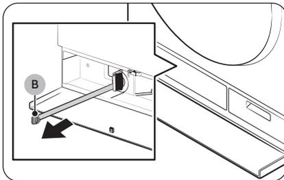
4. Stellen Sie in die Nähe der Abdeckung ein leeres Gefäß geeigneter Größe. Ziehen Sie den Notentleerungsschlauch dann heraus und legen Sie das Ende in das bereitstehende Gefäß. Halten Sie dabei die **Verschlusskappe (B)** fest.
