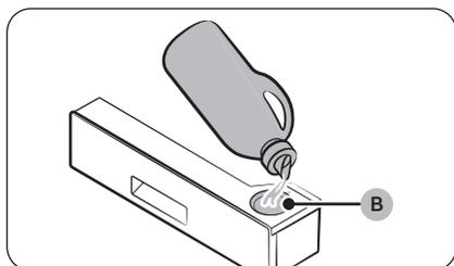
4. Geben Sie eine geeignete Menge Waschmittel in den **Standard-Tank der automatischen Dosiereinheit (B)**.
