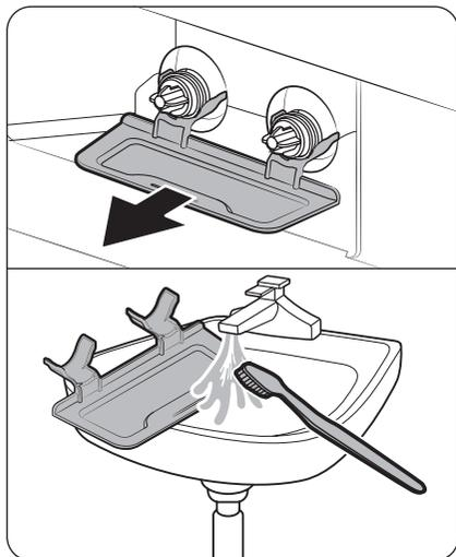
5. Nehmen Sie die Dosierschale heraus und reinigen Sie sie unter fließendem Wasser, um ausgelaufenes Waschmittel oder Weichspüler zu entfernen. Dann stellen Sie die Schale zurück.
