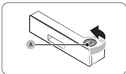
3. Drehen Sie den **Deckel der Standard-Tank der automatischen Dosiereinheit (A)** zum Öffnen gegen den Uhrzeigersinn.
