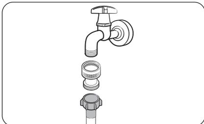
Bevor Sie den Wasserschlauch an einen Wasserhahn anschließen, müssen Sie das mitgelieferte Rückschlagventil an den Wasserhahn anschließen und dürfen erst dann den Wasserschlauch anschließen.
