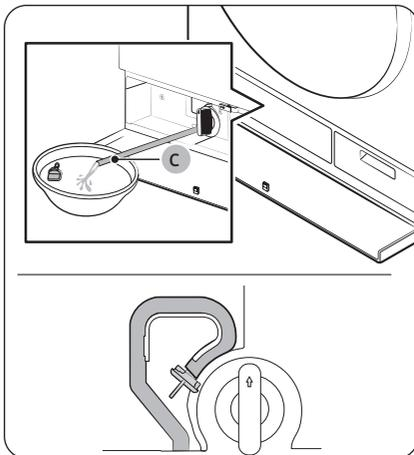
5. Öffnen Sie die Verschlusskappe und lassen Sie das Wasser über den **Notentleerungsschlauch (C)** in das bereitstehende Gefäß ab.
