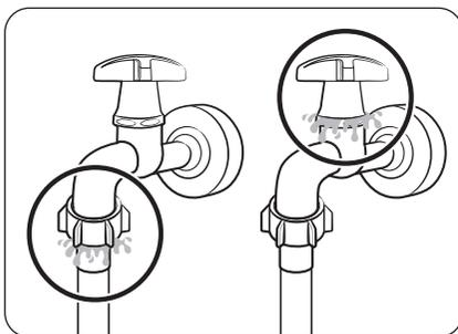
3. Öffnen Sie den Wasserhahn, und überprüfen Sie die Anschlüsse dann auf Lecks. Sollte tatsächlich Wasser austreten, müssen die Schritte 1 und 2 wiederholen.
