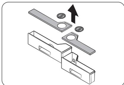
3. Entfernen Sie die Deckel der beiden Dosiereinheiten mit Hilfe der Zuglaschen an der Rckseite der Deckel.
