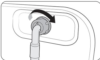
2. Schließen Sie das andere Ende des Frischwasserschlauchs an das Wassereinlaufventil auf der Rückseite des Waschtrockners an und drehen Sie den Überwurfing dann nach rechts fest.
