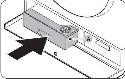
7. Setzen Sie den **Standard-Tank der automatischen Dosiereinheit (A)** wieder an seinen Platz.
