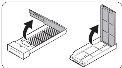
3. Öffnen Sie den äußeren Filter und entnehmen Sie dann den inneren Filter.
