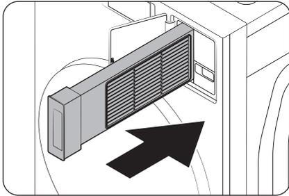
5. Setzen Sie den Innenfilter in der richtigen Richtung in den Außenfilter ein.
