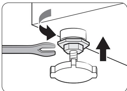
3. Wenn Sie das Gerät ausgerichtet haben, ziehen Sie mit dem Schraubenschlüssel die Muttern fest.
