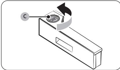
5. Drehen Sie den Deckel des **Flex-Tank der automatischen Dosiereinheit (C)** zum Öffnen gegen den Uhrzeigersinn.
