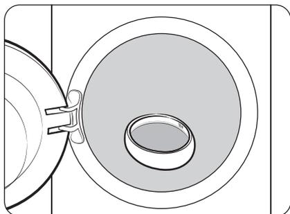
Füllen Sie die empfohlene Menge an flüssigem oder Waschmittelpulver in den Aqua Pebble und legen Sie den Aqua Pebble dann direkt in die Trommel. Im Inneren des Aqua Pebble befinden sich zwei Markierungen für 50 ml und 100 ml. Überschreiten Sie nicht die 100-ml-Einfüllhöhe.
