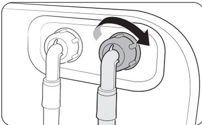
1. Schließen Sie das rote Ende des Warmwasserschlauchs an den Warmwasseranschluss auf der Rückseite des Wäschetrockners an.
