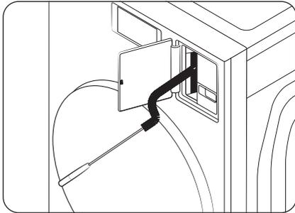
3. Reinigen Sie den Wärmetauscher mit einer Gerätebürste.
