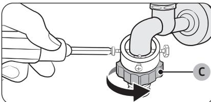
4. Schieben Sie den Adapter auf den Wasserhahn, ziehen Sie ihn hoch und ziehen Sie dann die Schrauben fest.
