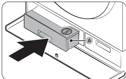
8. Setzen Sie die den **Standard-Tank der automatischen Dosiereinheit (A)** wieder an ihren Platz ein.
