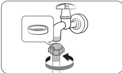
1. Verbinden Sie den Wasserschlauch mit dem Wasserhahn und drehen Sie den Überwurfing dann nach rechts fest.
