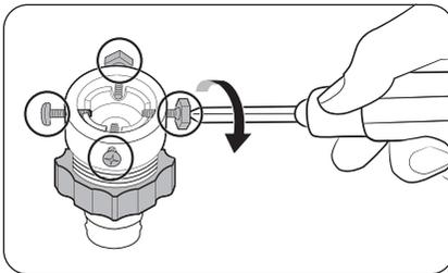
2. Lösen Sie die vier Schrauben am Adapter mit Hilfe eines Kreuzschlitzschraubendrehers.
