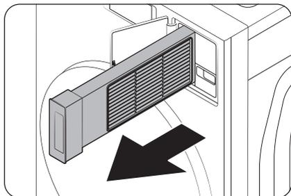
1. Öffnen Sie die Abdeckung des Flusensiebs.
