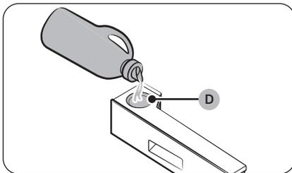
6. Geben Sie eine angemessene Menge Waschmittel (Universalwaschmittel oder Spezialwaschmittel) oder Weichspüler in den **Flex-Tank der automatischen Dosiereinheit (D)**.
