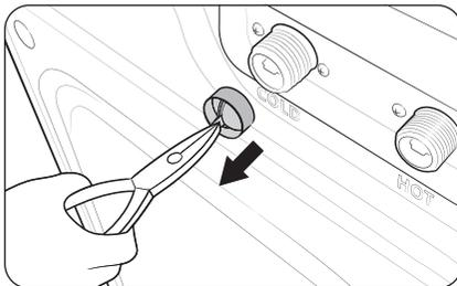
4. Ziehen Sie das Sieb mit einer Zange aus der Öffnung des Wassereinflussventils.
