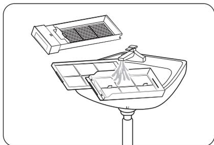
4. Entfernen Sie Flusen auf dem Innen- und Außenfilter. Waschen Sie die Filter dann unter fließendem Wasser und lassen Sie sie im Schatten vollständig trocknen.
