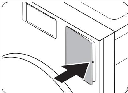
1. Drücken Sie auf die rechte Seite der Abdeckung des Flusenfilter, um sie zu öffnen.
