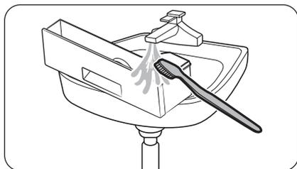
4. Reinigen Sie die Dosiereinheiten und alle anderen Komponenten unter fließendem warmen Wasser mit einer weichen Bhrste.
