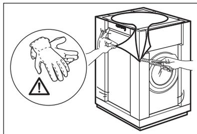
2. Entfernen Sie die Karton-Abdeckung und die Styroporverpackungsteile.
