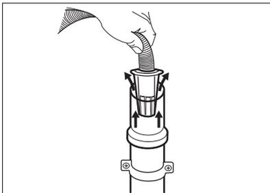
5. **Ohne Kunststofführung in einen Siphon** - Stecken Sie den Ablaufschlauch in den Siphon und befestigen Sie ihn mit einer Schlauchschelle. Orientieren Sie sich an der Abbildung.
