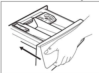
Vergewissern Sie sich, dass die Klappe beim Schließen der Schublade nicht blockiert wird.
