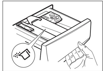
4. Um Flüssigwaschmittel zu verwenden, drehen Sie die Klappe nach unten.
