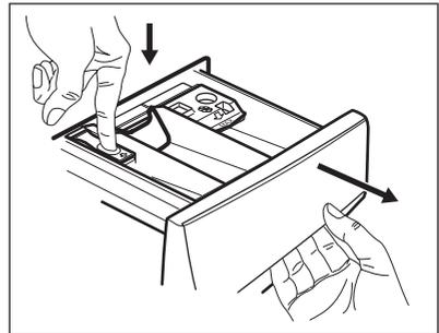
2. Um die Reinigung zu vereinfachen, entfernen Sie auch das Oberteil des Pflegemittelfachs. Stellen Sie sicher, dass alle Waschmittelreste an der Ober- und Unterseite der Aufnahme entfernt wurden. Reinigen Sie die Schubladenaufnahme mit einer kleinen Bürste.
