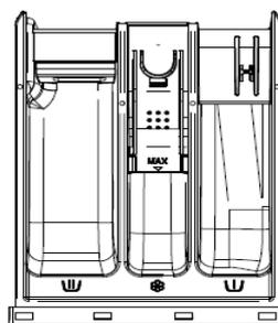
Die Waschmittelschublade besteht aus drei Kammern.
